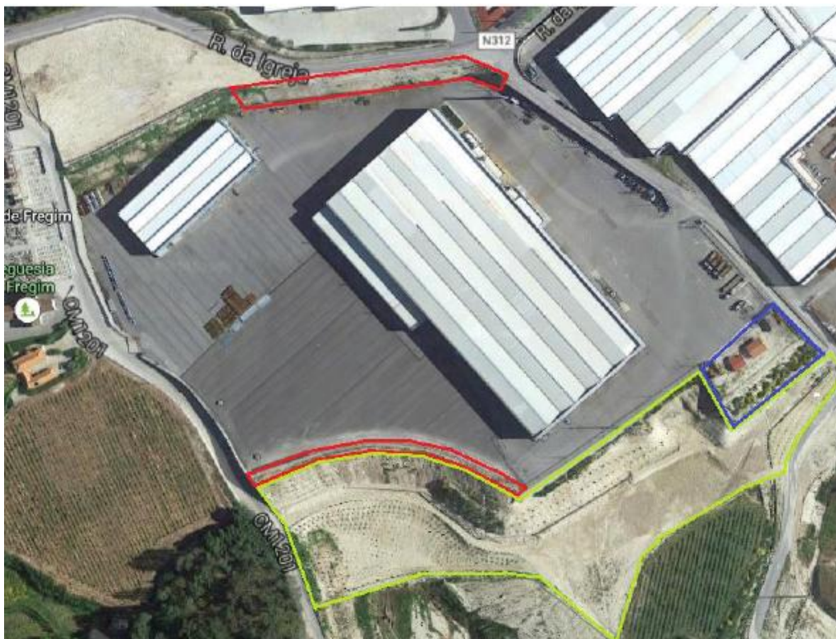
Figura 6: Divisão da superfície não impermeabilizada em 3 áreas: Azul – II; Verde – I2; Vermelho – I3 (Fonte: EIA – Julho de 2016).
